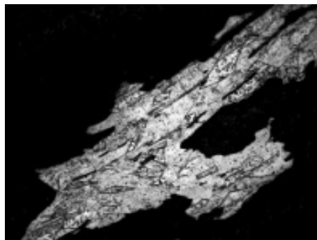
Figura 7: Metalografía de una plaquita de cobre a 500 aumentos (Cerro Turquesa). El metal presenta una microestructura compuesta de granos a sección poligonal. Al interior de estos últimos, podemos observar bandas de desplazamiento. Esto indica que la plaquita fue intensamente martillada en frío, después tratada térmicamente (recocido) y para terminar, ella recibió una última etapa de forja en frío.
